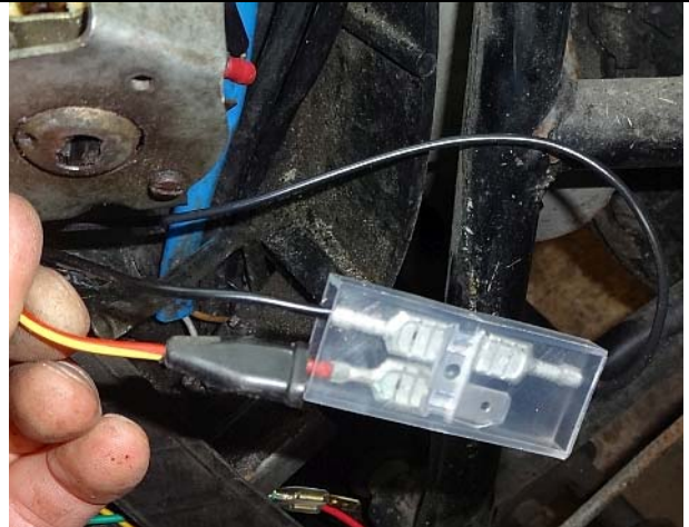
59a mit Masse Klemme 31 verbunden
