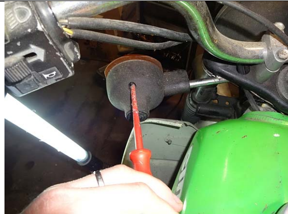
Blinker vorn mit den zwei Schrauben öffnen
