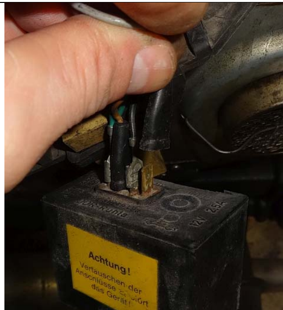
Klemme 49a an ELBA abziehen, an Klemme 49a (-) am Blinkgeber (siehe oben) anschließen
