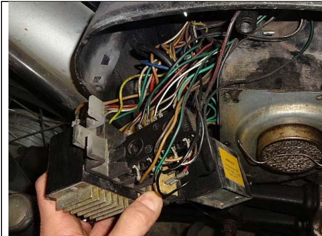
Halterung der Module herausnehmen
