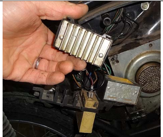
EWR abziehen und Anschlüsse zugänglich machen.
