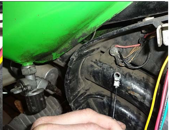
Schwarzes Massekabel Klemme 31 vom Regler am Massepunkt befestigen
