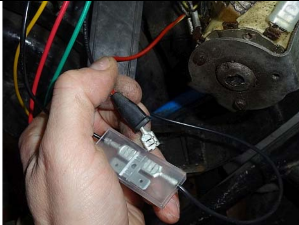
59a an Masseverbinder Kl. 31 anstecken
