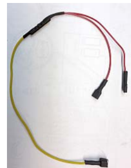
Kabel für Umbau der Blink-Kontrolllampe
