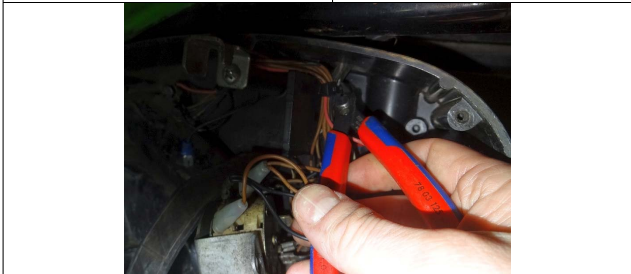
Kabelbinder hinter dem Zündschloss vorsichtig aufschneiden, um die Drähte beweglich zu machen.
