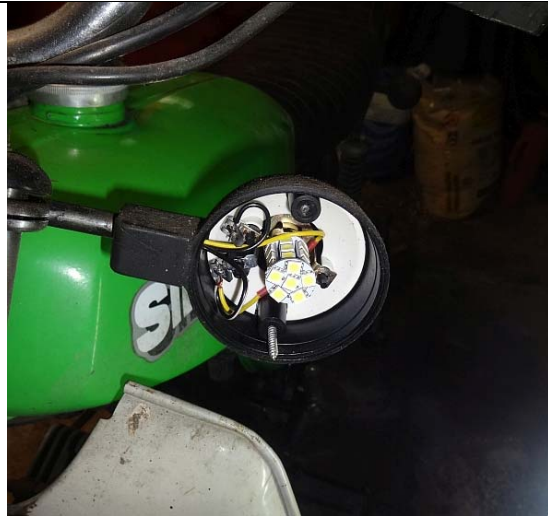
LED – Lampe eingebaut, Spiel in der Fassung prüfen und ggf. verkleinern
