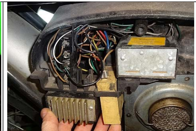
Schraube lösen und Modulhalter vorsichtig herausnehmen
