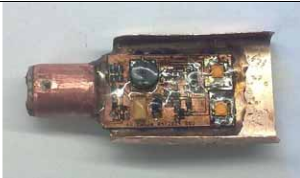
Lampe fertig vergossen, Abblendseite
