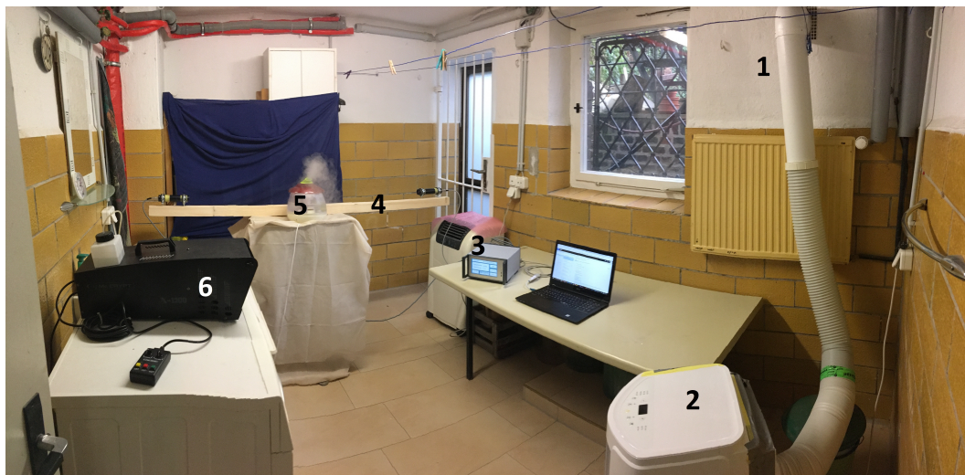
Abbildung 4: Ansicht des kleinen Modellraumes für erste praktische Auswaschversuche.
