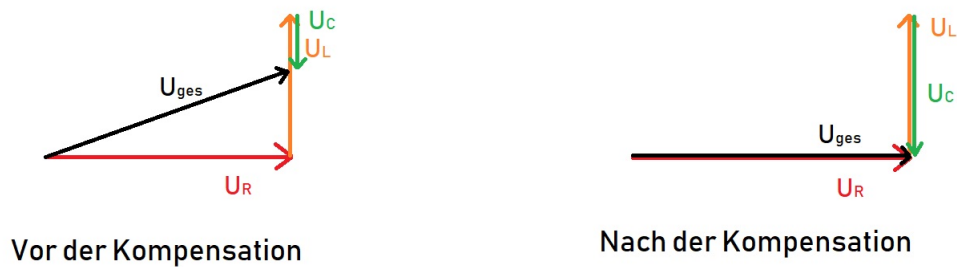
Abbildung 1.4: Zeigerdiagramm der Spannung vor und nach der Kompensation
