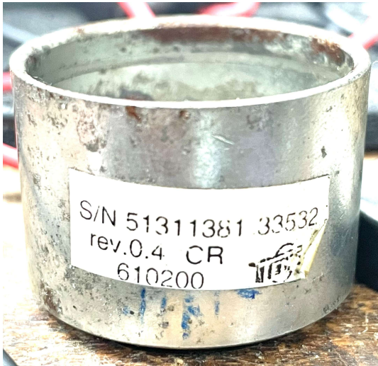
Abb. 17: Gehäuse des Piezo Sensors mit Sachnummer
