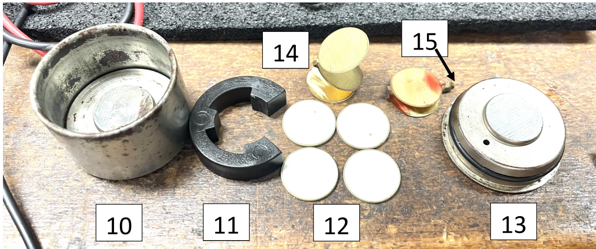
Abb. 15: Zerlegter Piezo-Sensor zur Messung der Druckänderungen während des Wuchtens
