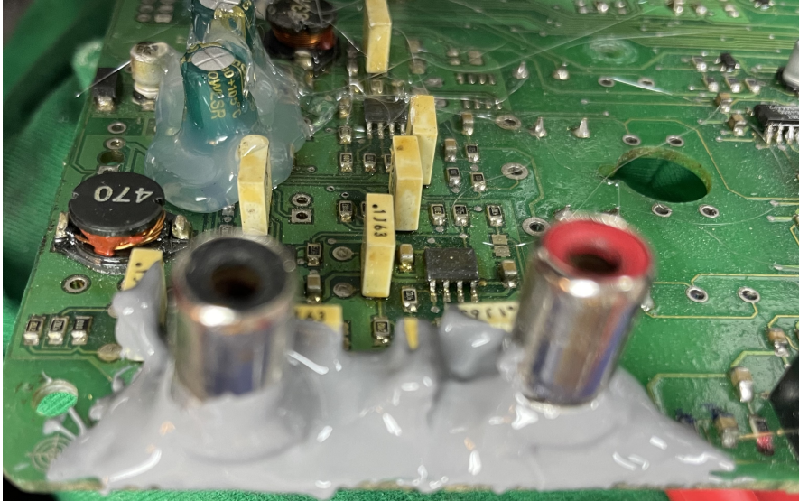
Abb. 14: Buchsen mechanisch fixiert an der Platine mit 2K-Chemical Metal
