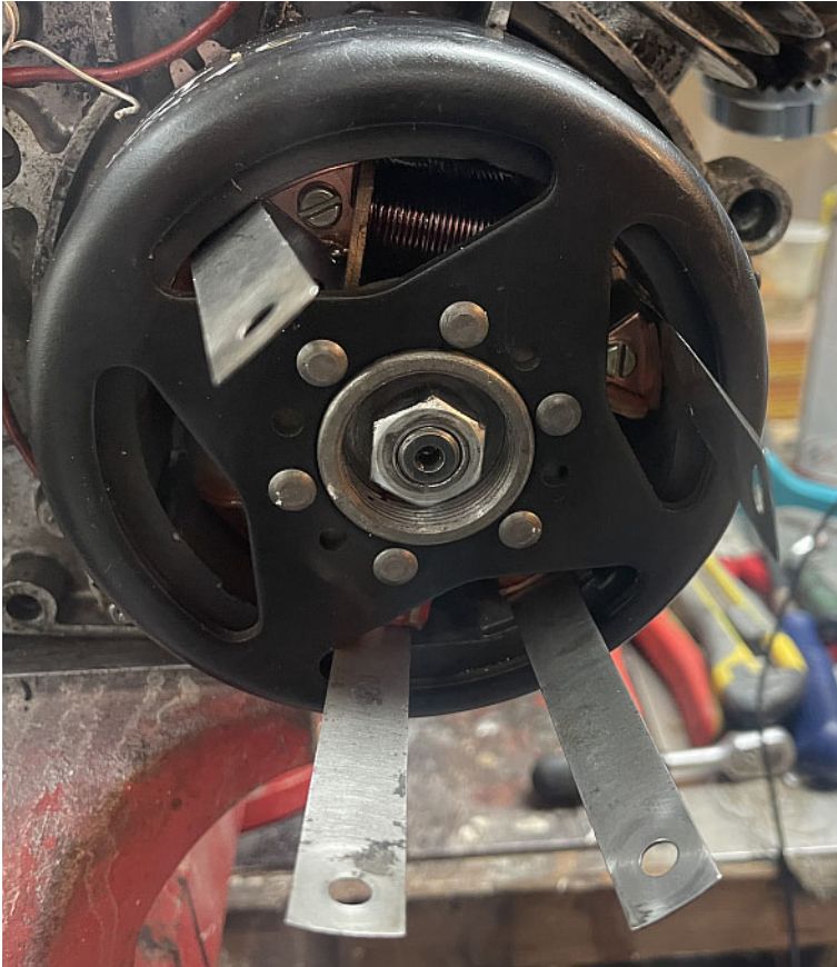
Abb. 13: Abstände der Spulen zu den Magneten mit Fühlerlehre vor dem Festschrauben der Grundplatte sicherstellen
