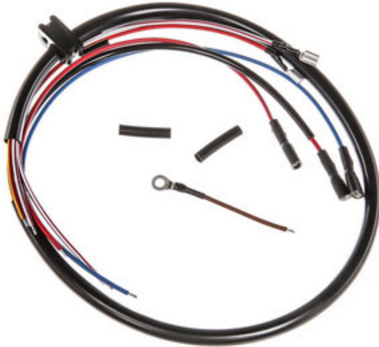
Abb. 9: Kabelsatz für 6V- Grundplatte geeignet für KR51-1
