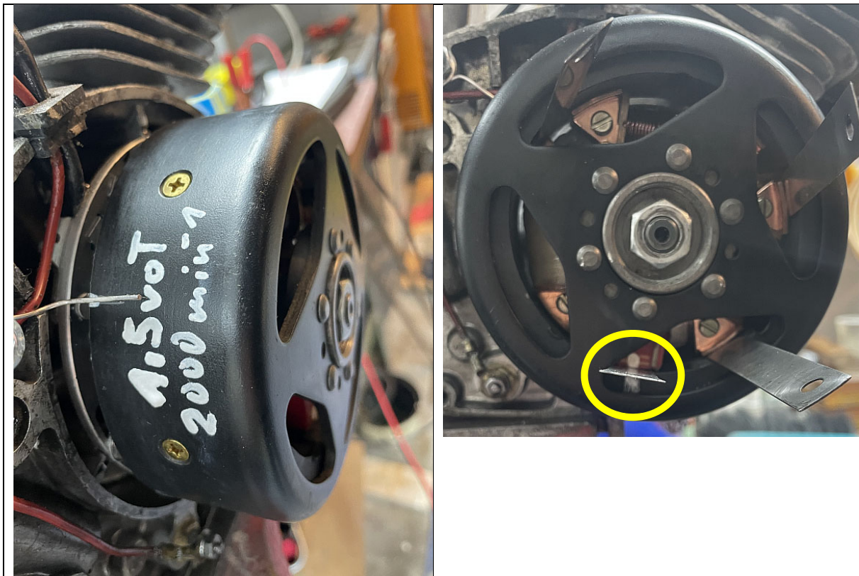
Abb.20: Voreinstellung Schwungrad und Grundplatte auf 1,5 vOT beim M54 Motor des Sperbers, mittels Fühlerlehren die Magnetspalte auf etwa 0,3 mm am gesamten Umfang konstant halten.
