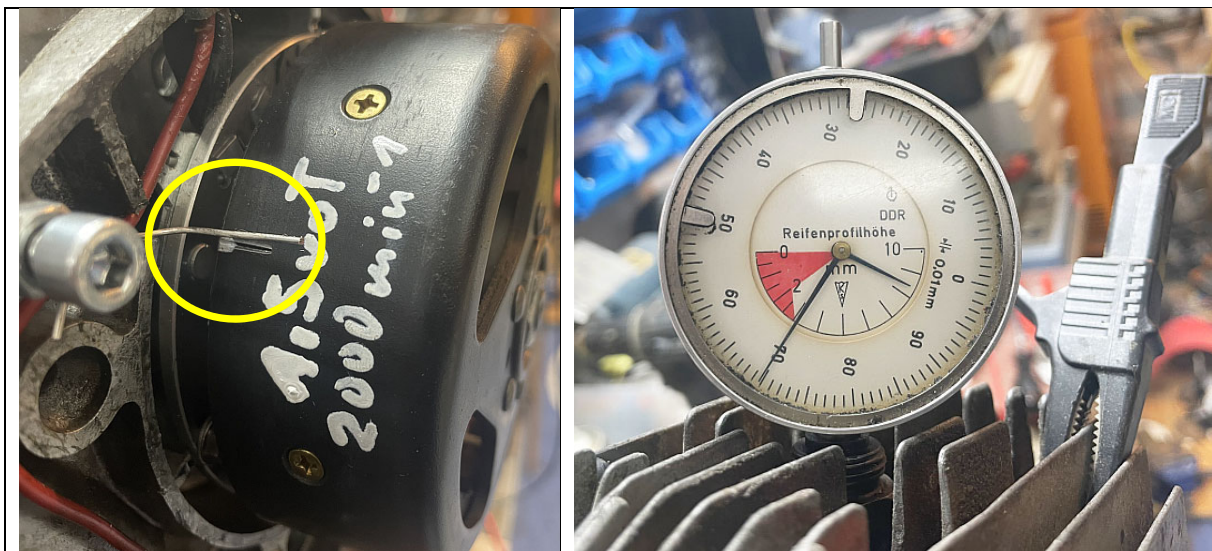
Abb.19: Zu früher ZFP mit etwa 1,7 mm vOT bei mittlerer Drehzahl
